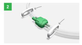
Steng av kanisterslangen og bandasjeslangen ved å plassere klemmene tett inntil hver sin side av den grønne koblingen. Skyv så klemmene over i lukket posisjon. Dette klemmer av slangene slik at de blir tette.
