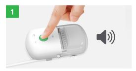
Sett pumpen på pause ved å trykke på den grønne startknappen, og slipp den opp etter to (2) sekunder. Pumpen vil pipe to ganger for å signalisere at den er i pausemodus.
